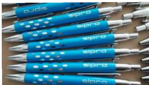
Tampotisk je tehnika prenosa barve iz klišaja preko gumijastega tampona na izdelek. Zaradi prožnosti tampona je s to tehniko možno tiskati na izdelke z manjšimi in neravnimi površinami. Namenjen je tisku logotipov na manjše površine, kjer tiskamo s tankim nanosom barv v izredno visoki lo ljjosti. Tiskamo lahko na kovino, steklo, usnje, umetne materiale, les in PVC.
